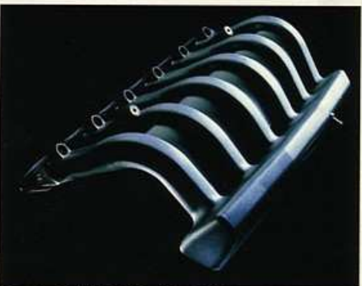
Sauganlage leicht: Die leichten Kunststoffrohre vermindern auch das Ansaugergeräusch. Die Bohrungen für die Einspritzventile rückten für besseres Ansprech- und Abgasverhalten näher an den Zylinderkopf
