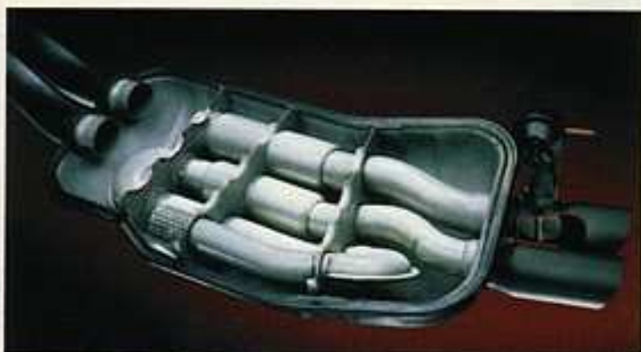
Offen auf Zeit: Die Auspuffklappe schließt bei niedrigen Touren gegen Dröhnen ein Endrohr
