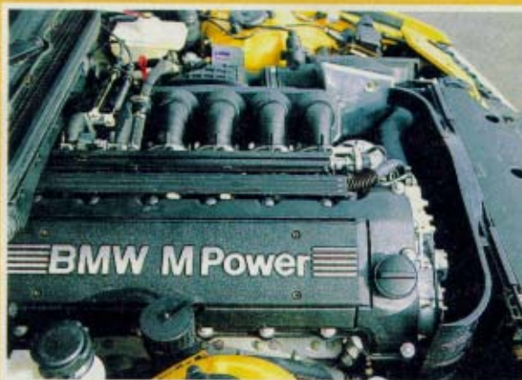
3,0 Liter, Grauguß-Block, Einzeldrosselklappen, stufenlose Nockenwellen-Verstellung beim M3
