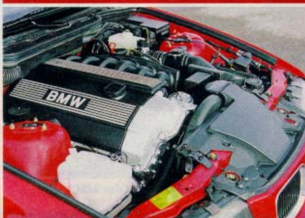
2,8 Liter, Aluminium-Block und einstufige Nockenwellen-Verstellung beim Motor des 328i
